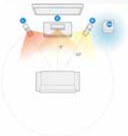
3.1-Kanal Eine Center-Box vorne in der Mitte verbessert Dialoge.
