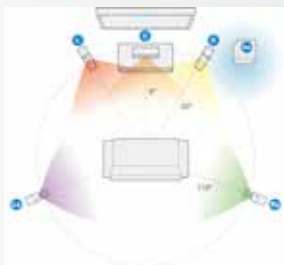
5.1-Kanal Surround-Boxen hinten links und rechts sorgen fürs Raumgefühl.
